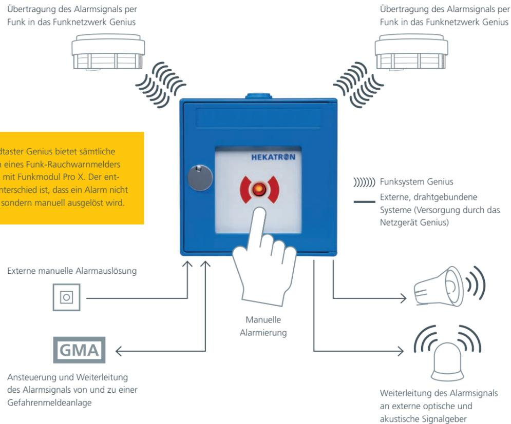
Der Funkhandtaster Genius bietet sämtliche Eigenschaften eines Funk-Rauchwarnmelders Genius Plus X mit Funkmodul Pro X. Der entscheidende Unterschied ist, dass ein Alarm nicht durch Rauch, sondern manuell ausgelöst wird.
