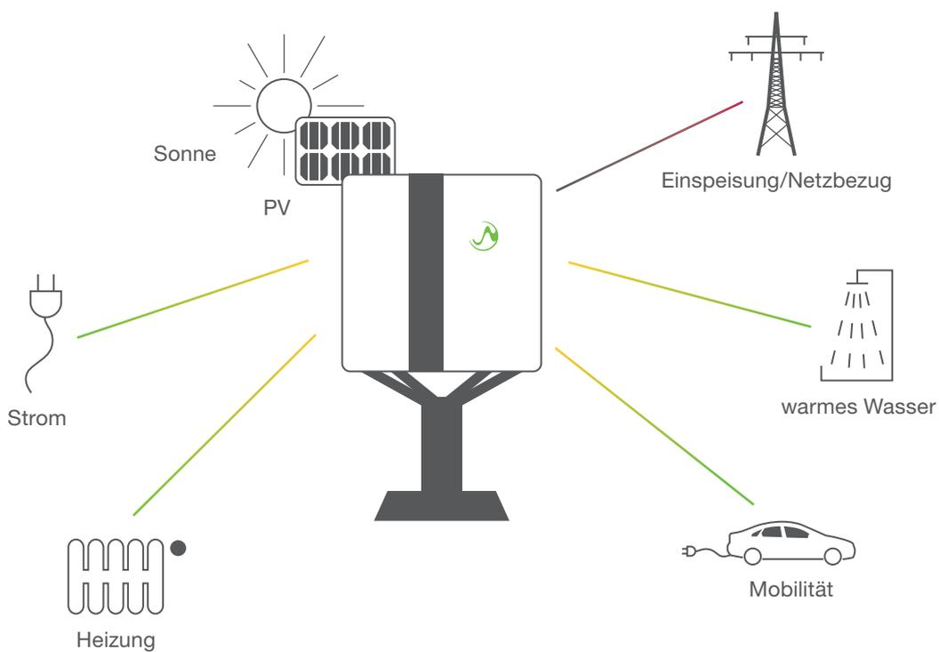
Das Hauskraftwerk ist das Herzstück dessen, was Sektorenkopplung genannt wird: Sauberer Solarstrom fließt über das Hauskraftwerk vorrangig in Haushaltsgeräte, Wärmepumpen oder andere elektrische Heizgeräte und ins Elektroauto. Nur der Strom, der im Haus nicht verbraucht werden kann, geht ins öffentliche Netz.
